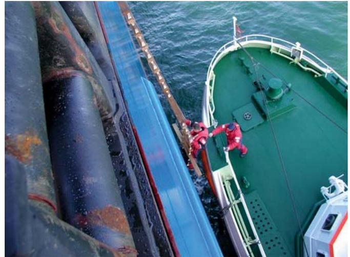
Abb. 4 Überstieg auf einen Bulkcarrier unter Verwendung einer sog. Lotsenleiter.
